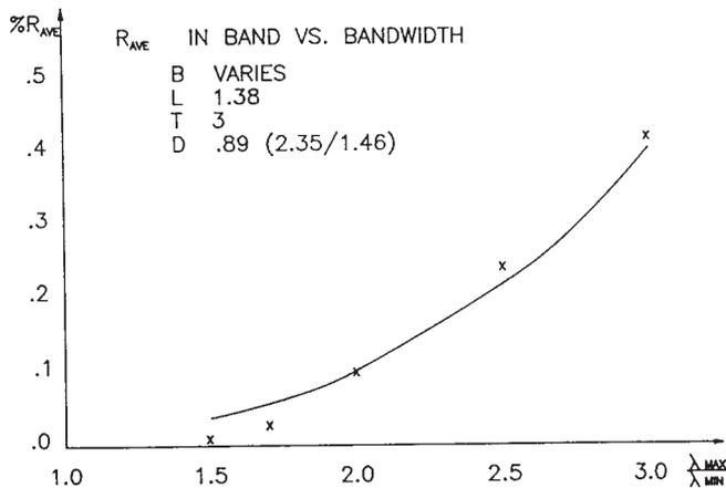
FIG. 3. AVERAGE REFLECTANCE IN BAND VERSUS BANDWIDTH. CURVE IS FROM FORMULA, X'S ARE EMPIRICAL DATA.
