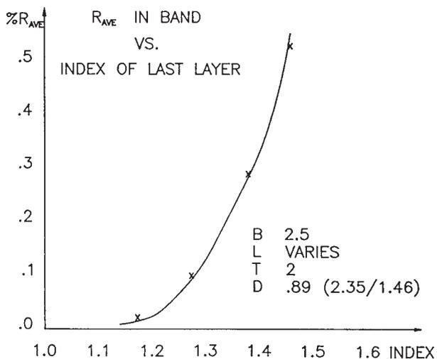
FIG. 4. AVERAGE REFLECTANCE IN BAND VERSUS REFRACTIVE INDEX OF LAST LAYER. CURVE IS FROM FORMULA, X'S ARE FROM EMPIRICAL DATA.
