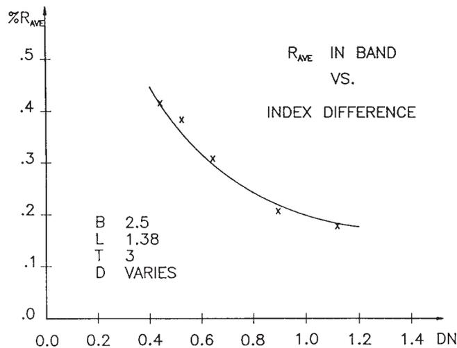
FIG. 6. AVERAGE % REFLECTANCE IN BAND VERSUS INDEX OF REFRACTION DIFFERENCE IN ALL LAYERS EXCEPT LAST. CURVE FROM FORMULA, X'S FROM EMPIRICAL DATA
