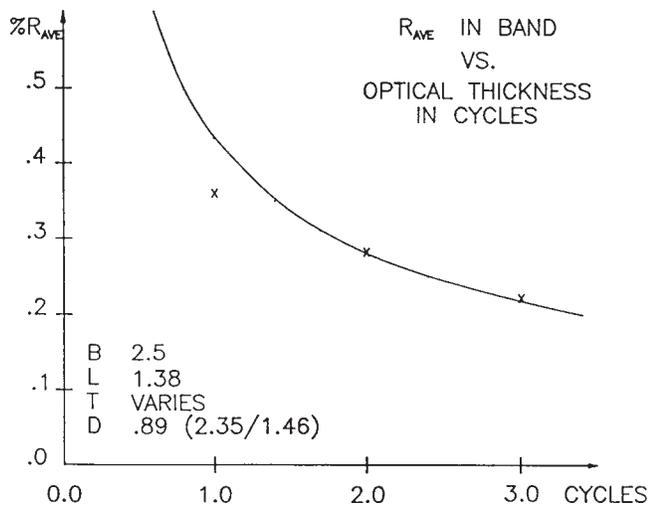
FIG. 7. AVERAGE REFLECTANCE IN BAND VERSUS OPTICAL THICKNESS IN CYCLES OR WAVES AT LONGEST WAVELENGTH OF THE BAND. CURVE IS FROM FORMULA, X'S FROM EMPIRICAL DATA.
